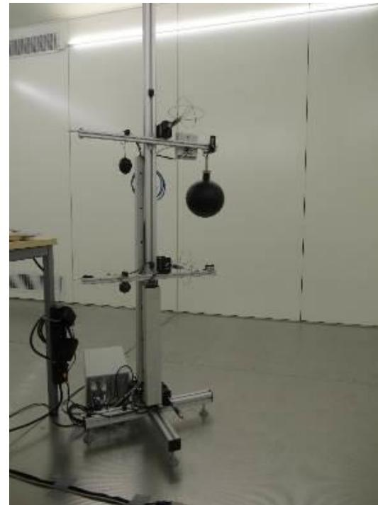
Globe-Thermometer für die Bestimmung der operativen Raumtemperatur
